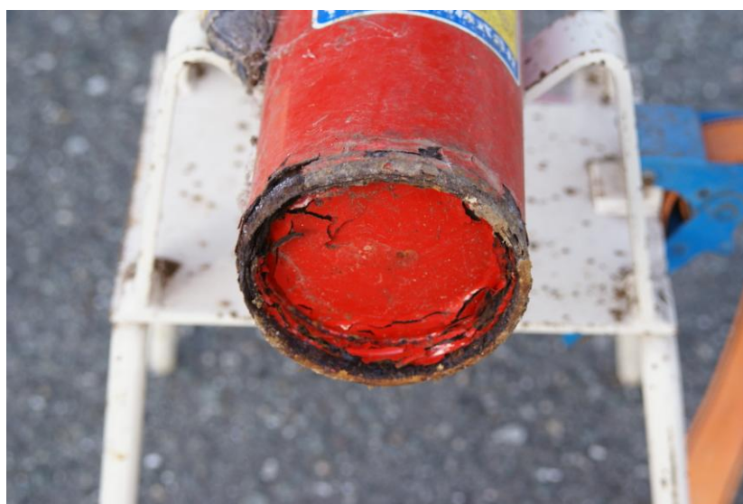
腐食している消火器
