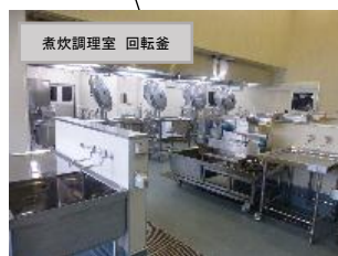
回転釜で煮炊き調理や汁物調理をします。1釜で約800人分の調理ができます
