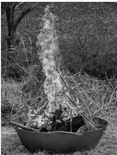
▶無煙炭化機を利用しバイオ炭づくり（上八代宮農組合）
