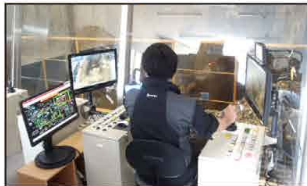
クレーンでごみを攪拌・移動しています
