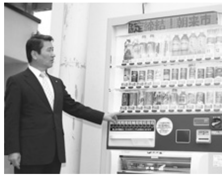
和田山中央文化公園に設置された災害対応型自動販売機。上部の電光掲示板に災害情報が流れます。
